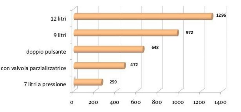
Consumi annui di diversi apparecchi di scarico per WC (dati in millioni di metri cubi)
