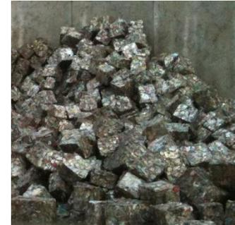
**Frantumazione:** Tale sistema, si basa principalmente su due operazioni: triturazione con conseguente riduzione volumetrica e vagliatura / deferrizzazione del materiale trattato.
